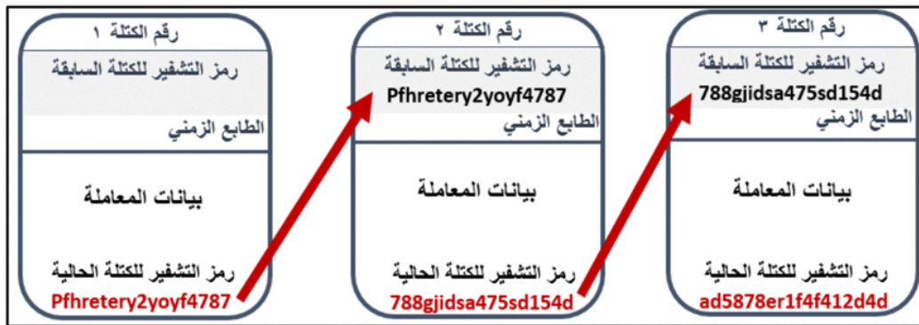
الشكل رقم (٤) البنية الأساسية وكيفية تشفير الكتلة باستخدام دالة الهاش
